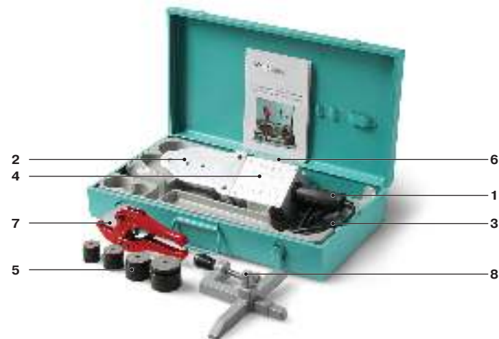
1–рукоятка; 2–нагревательная панель; 3–шнур с вилкой; 4–регулятор температуры; 5–сменные насадки; 6–выключатель-индикатор питания и нагрева; 7–резак; 8–подставка.
